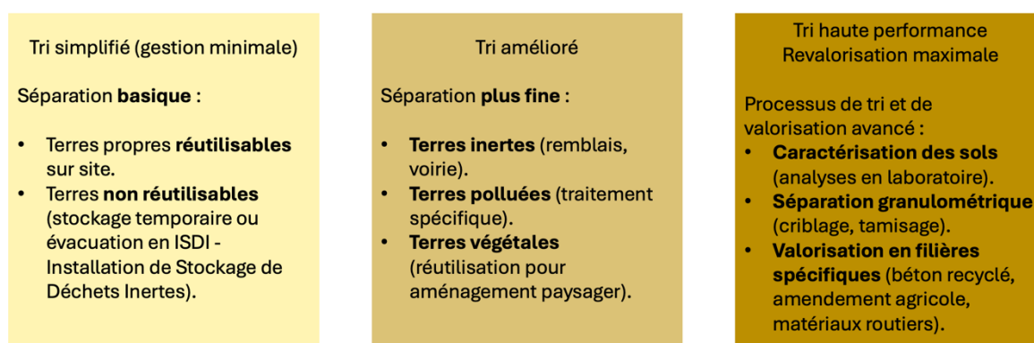
Figure 20 : Différentes méthodes de tri selon les ambitions de revalorisation ©ARP Astrance
